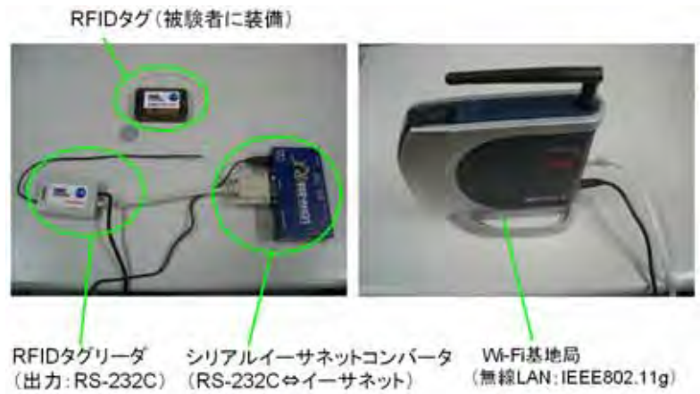
図 3-3 [無線装置] Wi-FiアクセスポイントとRFIDタグ・リーダの外観
