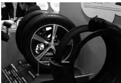
静音タイヤの実物展示。ハンマーでたたいて効果を体験できる。構造はカットモデルで示している。
