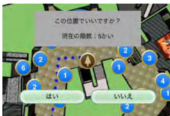
図 2 - 5 6 [位置補正画面] 直前に表示された地図の中央を現在位置、画面上方を進行方向として補正情報をセンサに通知する。
