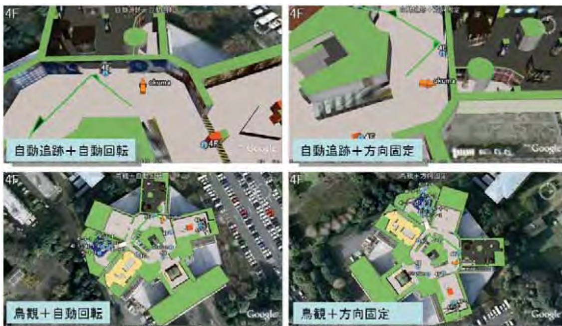
図 2 - 8 [H19 仮想視点制御] 仮想視点制御モードの比較
