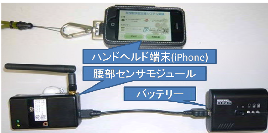
図 2 - 4 0 [利用者端末] iPhone とセンサモジュール
