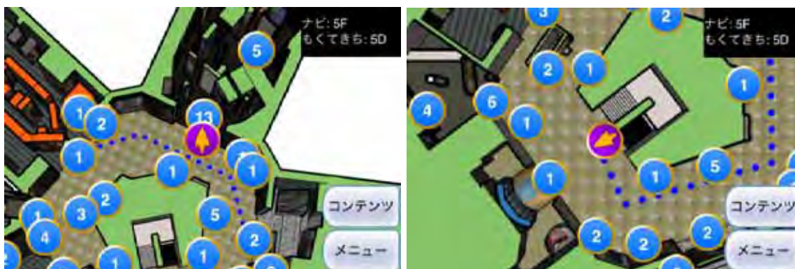
図 2 - 4 8 [自動回転] (左) 自動回転モード。進行方向が画面の上方向と一致する。 (右) 方位固定モード。画面の上方向が常に北を示す。
