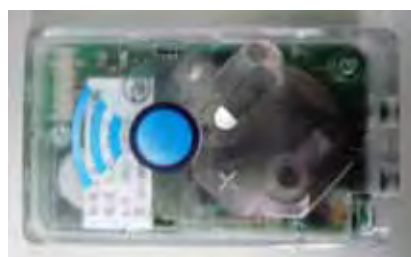
図 2 - 4 1 [アクティブ RFID タグ] 環境側に配置されたアクティブ RFID タグ (50mm × 28mm × 11mm)
