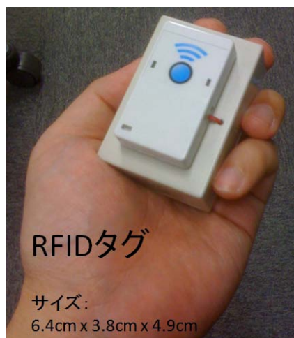
図[アクティブ RFID タグ] 環境側に配置されたアクティブ RFID タグ (左：昨年度、右：今年度)
