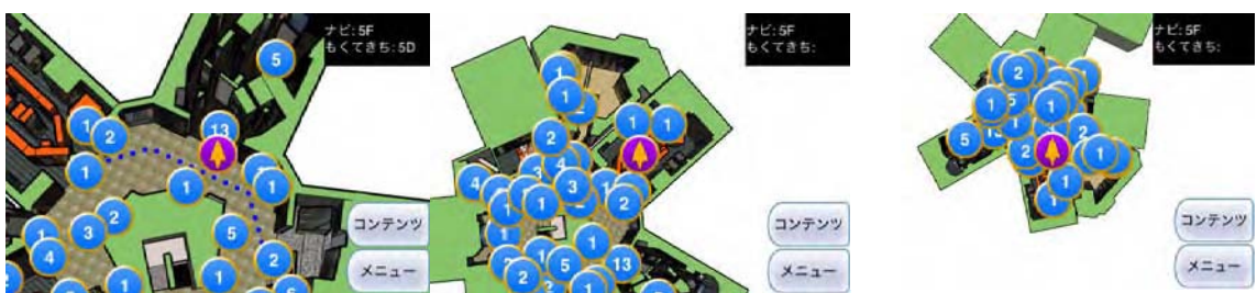
図【自動縮尺】 測位系の不確かさに基づき縮尺が変化する様子
