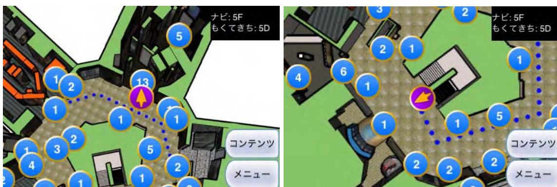
図【自動回転】 (左)自動回転モード。進行方向が画面の上方向と一致する。(右)方位固定モード。画面の上方向が常に北を示す。
