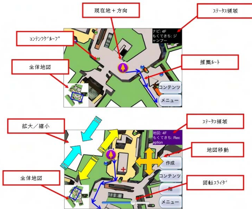
図[画面：地図自動・手動]地図自動モード（画面右上のステータス領域に“ナビ”と表示）と地図手動モード（ステータス領域に“地図”と表示）の画面の例と操作方法
