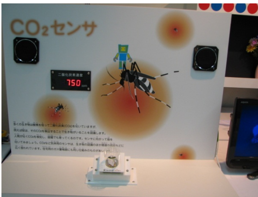
図 26 手前の筒に息を吐きかけることで、二酸化炭素濃度の値(ppm)が変化する二酸化炭素センサ体験。
