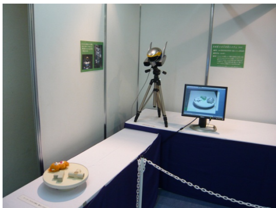
図 2 「VVV」全景。手前のターンテーブル上を奥のロボットヘッドが“見て”おり、角ばったブロックの位置や向きを“認識”した様子がモニタに表示されている。
