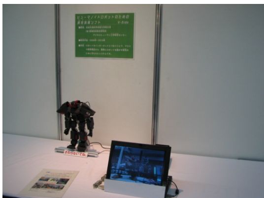
図 6 「V-Sido」システム全景。左のハードウェアと右の PC ソフトウェアで相互に制御可能。
