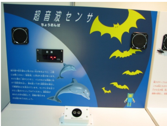
図 28 手前の黒い部分にかざした物体までの距離(cm)が表示される超音波センサ体験。
