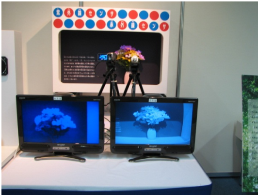
図 29 左側が紫外線で、右側が赤外線それぞれ“見た”同じ花束の様子。いずれもヒトの眼にはモノクロ的に見えるが、何が強調されているかは大きく異なる。
