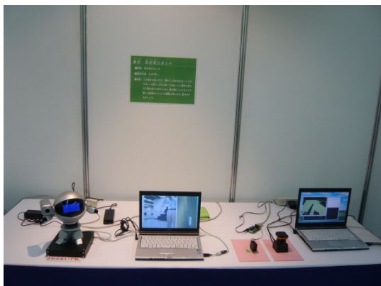
図 3 左が受付・防犯用ロボット。右肩に担いだカメラで写した様子が中央の PC 画面に映される。右は測域センサ。右の画面の黒い部分が障害物。
