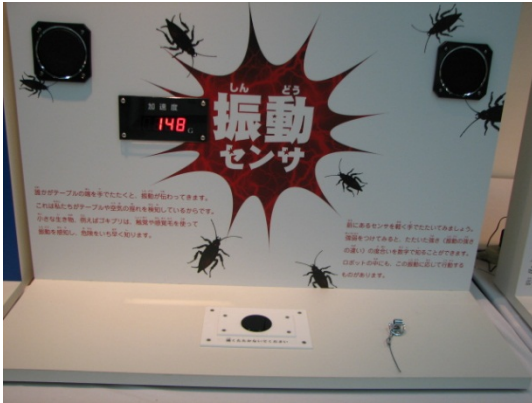
図 27 手前の黒い部分を叩くことで、その際の加速度が検出される振動センサ体験。
