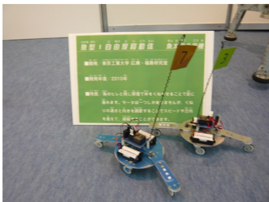
図 19 単 3 型乾電池 2 本で動作する「魚太郎 3 号機」2 体。数字「3」「7」はラジコンのチャンネルを示す。
