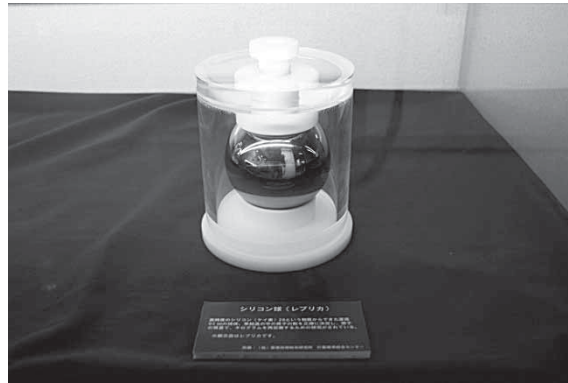
次世代のキログラムの定義を目指して開発中のシリコン球
