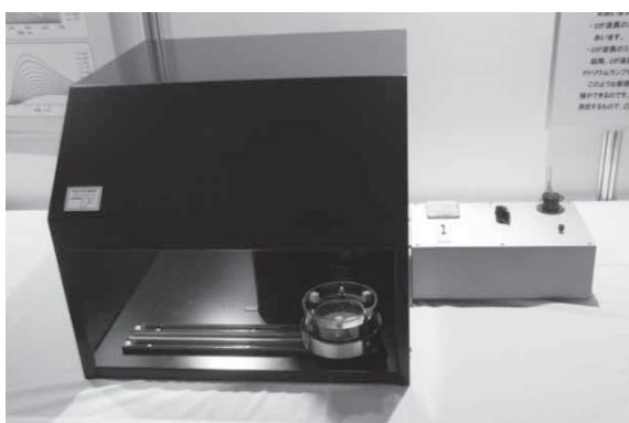
ニュートンリング観察器展示物全景 光源には LED とナトリウムランプを使用
