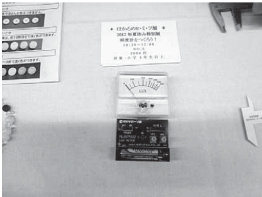
照度計の完成品
