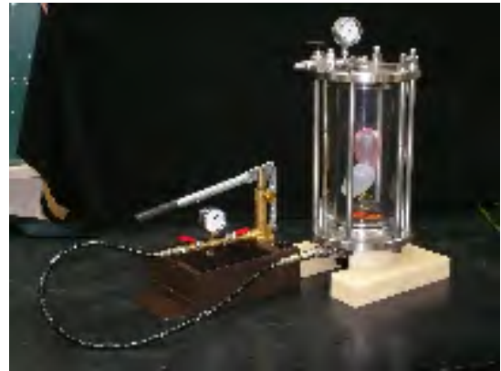
<写真4 加圧水槽と手押し式ポンプ>
