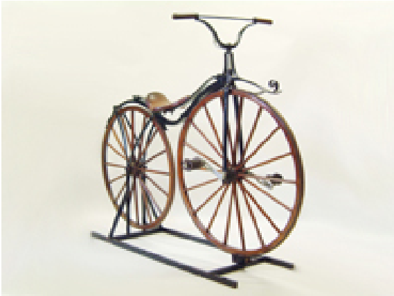
写真7 世界最初のペダルが付いた自転車 ミショー型自転車
