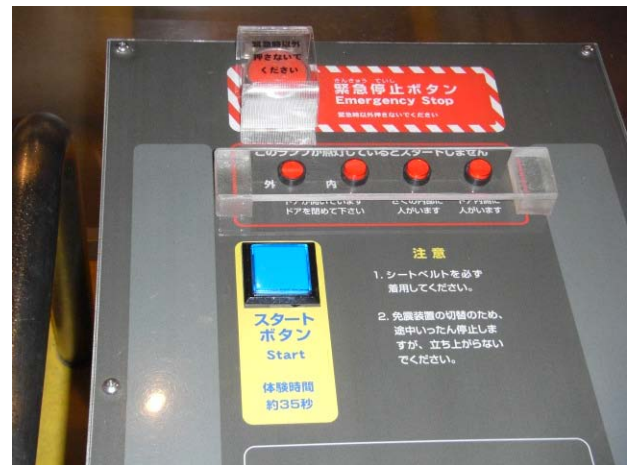
写真 3 来館者操作部にアクリルカバー取付け
