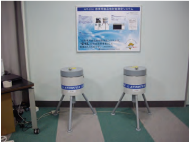
写真 10 教育用食品放射能測定システム (2台)
