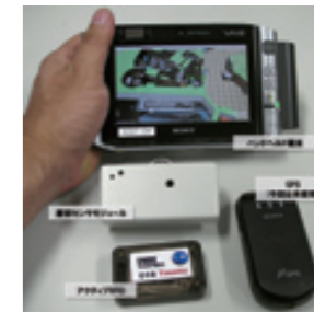
【屋内ナビゲーションシステム】 ハンドヘルド端末、腹部センサモジュール、アクティブRFIDから構成される
