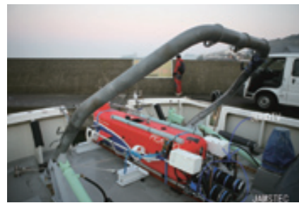
【3次元撮影システム】 科学技術館がJAMSTECと共同開発した深海の様子を3次元撮影するシステム。深海探査船の先端に設置
