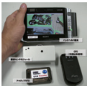
【ウェアラブル機器を利用した科学館学習支援システムに関する研究開発】 身体に装着するシステムの機器類。センサやアンテナ、ハンドヘルド端末などで構成
