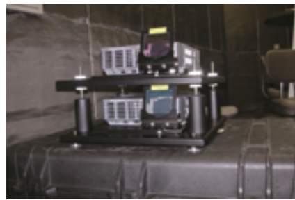
【可搬型投影システム】 4次元デジタル宇宙映像を、科学館や学校などに持ち出して上映できるシステム。科学技術館が設計・製作を担当
