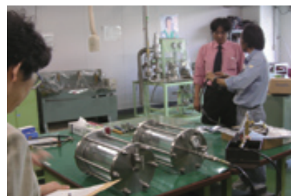
【ハードウェアの開発】 深海をテーマにした教育プログラムで使用する加圧水槽を設計、製作（加圧実験水槽の開発と授業の実施）
