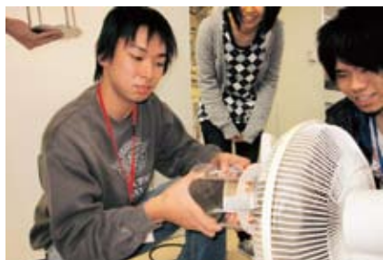
【風力発電機の扇風機テスト】 まずは扇風機でテスト。ここで動かないと次の風洞実験には進めない
