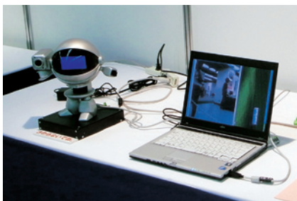
【受付・防犯用ロボット】 人の動きを感知して、カメラが人のいる方向に追随する動作をするロボット
