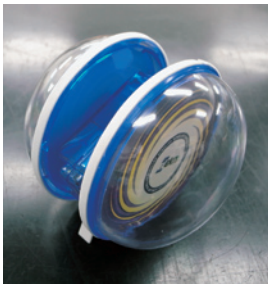
【スクローラーⅡ】 側面のドームが回転しながら走行し、倒れても自動的に起き上がる動作をする工作キット
