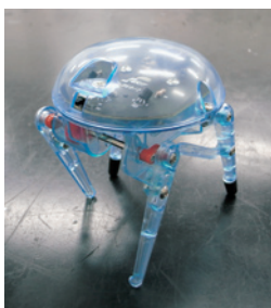
【メデューサ・ネオ】 センサーにより音や振動を感知して4足歩行するロボット工作キット
