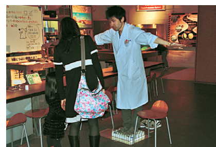
【名波先生が乗ってもつぶれないコピー用紙の筒100個】 手のひらにのるくらいに正六角柱の筒をコピー用紙で100個作り、それを蜂の巣のようなハニカム構造につなげると……思わず来館者も寄ってきます
