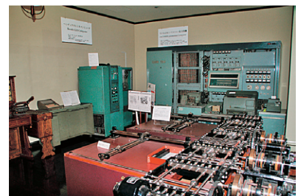
【FACOM201 パラメトロン電子計算機】 1960年から東京理科大学で教育・研究用に使用していた大型計算機
