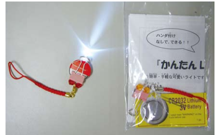
【かんたんLEDライト】 名波先生が開発した工作キット。クリップの柄がスイッチになるのがポイント!
