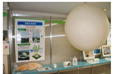
【ラジオゾンデ】 ゴム気球にセンサーを吊るして上昇しながら上空30kmまでの気圧や気温などを観測し、無線でデータを送る「ラジオゾンデ」
