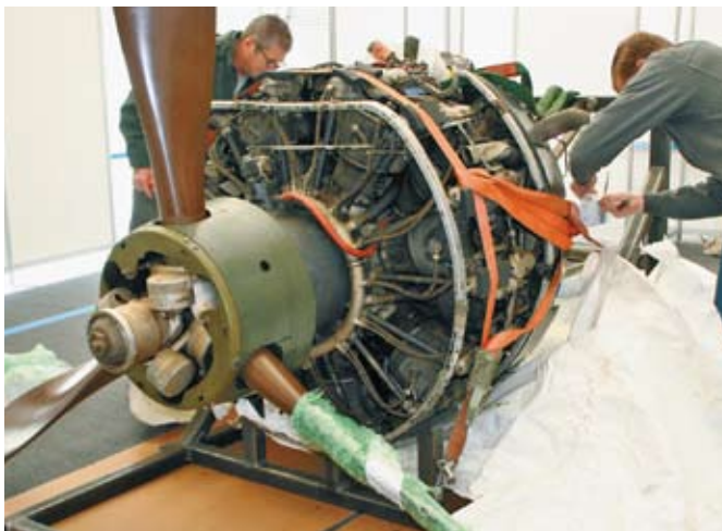
▲「栄二型エンジン」の梱包が解かれ、フォークリフトを使い、零戦本体部分と丁寧に接続する
