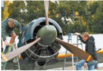
▲プロペラのノーズ部分(写真左)や、貴重な「栄二型エンジン」(写真中央)に各カウリング(カバー)を施す
