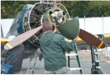
▲プロペラのノーズ部分(写真左)や、貴重な「栄二型エンジン」(写真中央)に各カウリング(カバー)を施す
