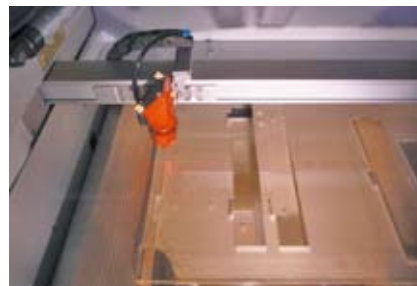
【レーザー加工機内部】 赤いレーザーヘッドがアクリル樹脂を蒸発させながら動き、実験装置の部品を切り抜いている
