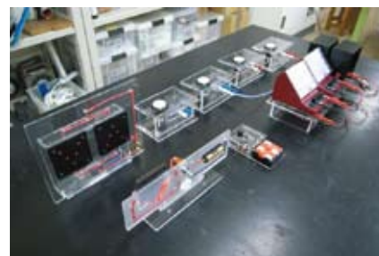
【三菱電機株式会社と共同開発している実験プロ グラム用の装置】 三菱電機株式会社と共同開発している装置の 数々。アクリルはレーザーで加工しやすいだけ なく、透明なので科学教育に適している
