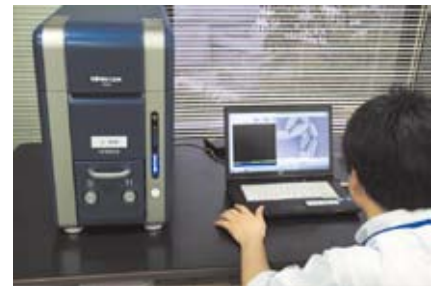
【導入事例2：日立ハイテック Miniscope®】 日立ハイテクノロジーズの卓上顕微鏡 Miniscope® TM3000。最高倍率3万倍程度の能力を有する
