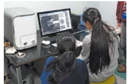
【導入事例1：日本電子 NeoScope™】 日本電子の卓上走査電子顕微鏡 NeoScope™JCM-6000を使用する受講者。タッチパネルで操作も簡単。数分程度の真空引きで使用可能
