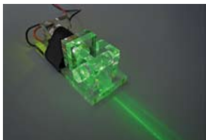
【動作中の「レーザー光路表示器」】 レーザー光がアクリル円筒の中心線と交差するよ うに、アクリル製の部品で固定されている
