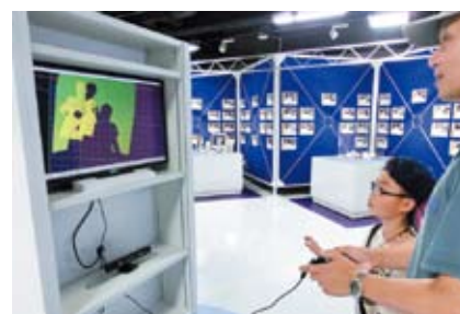
【3D スキャナー】市販ゲーム機とセットで販売されているセンサーを流用した3D スキャナーで自分の3D モデルを見る体験ができる
