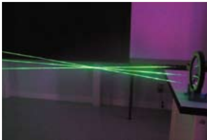
【光のじっけん室・凸レンズの実験】 3本のレーザー光線を凸レンズに通し、霧吹きによって焦点付近の光の道筋を浮き出させている
