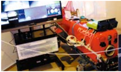
【深海生物追跡ロボットシステム「PICASSO」】水深1,000mまで探査！（海洋研究開発機構提供）
