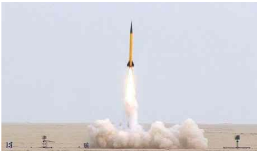
ARLISS でのロケット発射の様子。ロケットは高度約4,000mまで上昇し CanSat を分離して降下させた
