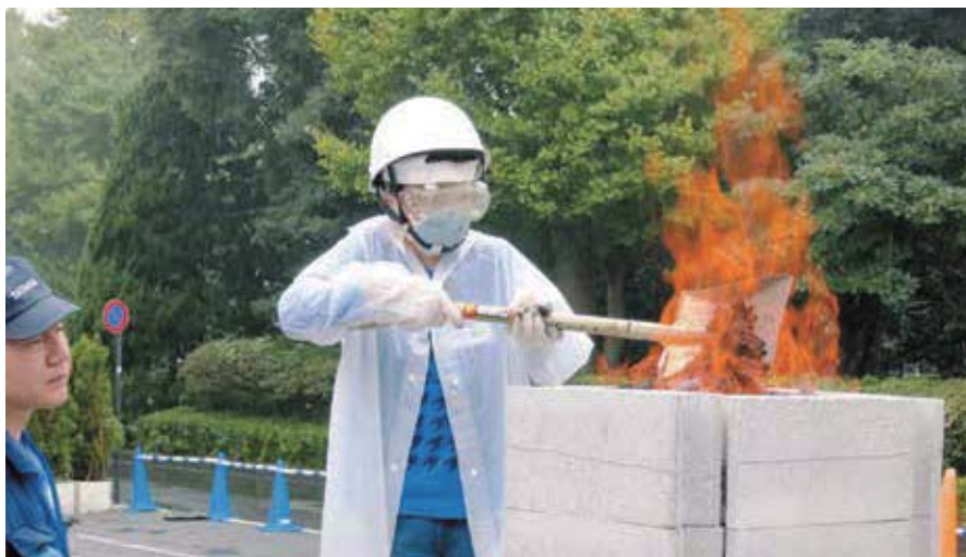
炎が立ち上る炉へ、原料の砂鉄を入れる
