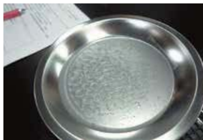
地学分野（11月23日）：液層を下から熱するとセル状構造が生じるペナル型対流の観察
