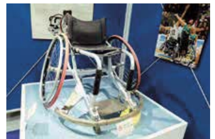
バスケットボール用車いすで、激しい衝突に耐えるようバンパーがついています
