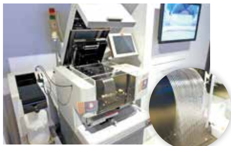
「RISA シーケンサー」と、その中央にセットする、384本のガラス管を束ねたキャピラリーカセット
