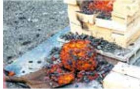
炉を加熱しながら砂鉄と木炭を交互に繰り返し入れて、約3時間にわたり炉を加熱したところ、5kgを超えるケラ（純度の高い鉄を含む塊）をつくることができました（写真上）。
