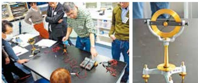
誘導起電力に着目した電磁誘導実験の様子。右は地磁気を調べる伏角方位磁針
