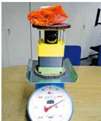
当プロジェクト実施のための実証実験として製作した CanSat。4K カメラを搭載し、GPS 受信機と通信用の無線機を内蔵
