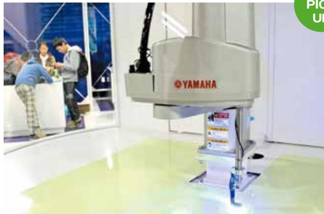
水平方向に柔軟に動く「スカラ (SCARA) ロボット」。2006年にカーネギー・メロン大学のロボット殿堂入りも果たした
