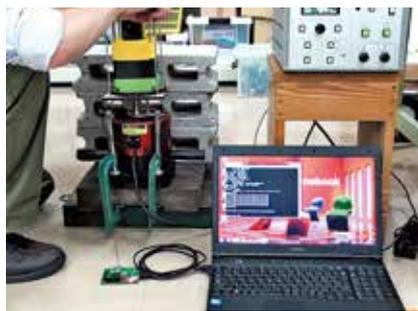
打ち上げ時の強い振動に耐えられるよう、加振機による振動試験を行った。他にも落下試験など過酷な試験に耐えなければ打ち上げは許可されない
