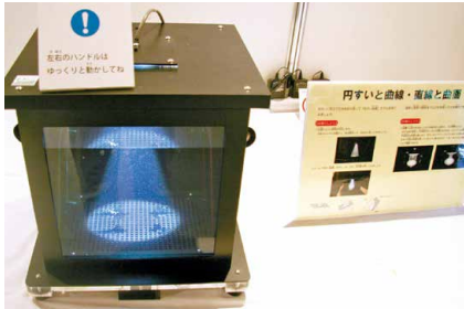
【円すいと曲線】横にあるハンドルを上下させて、水槽内にある網目状の板の角度を変えると、光でできた円すいの断面形状が変化する
