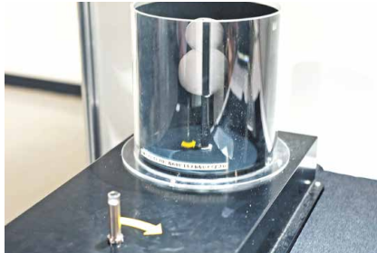
【回転する回転体】手前のつまみを回して筒内の棒にさしたピースを回転させると、残像で立体が現れる
