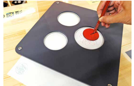
【歯車の図形】内歯車にペン穴が開いた平歯車を噛み合わせて平歯車を回転させると色々な模様が現れる。ペンを入れる穴の位置により模様に変化
