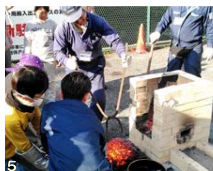
1. JFE スチール株式会社東日本製鉄所（千葉地区）を見学。鋼片を多様な厚さの鋼板に加工していく熱間圧延工場の様子。 2. 鉄鋼産業とたたら製鉄についての講義の様子。鉄の使い方や性質、鉄鋼産業の歴史などについて学んだ。 3. 炎が立ち上る炉へ原料の砂鉄を入れる。炉を構成する耐火レンガは黒崎播磨株式会社より提供。 4. 約3時間の間、鞆（ふいご）を交互に踏んで途切れることなく炉に風を送りつける。 5. 赤熱した鋳（ケラ）を取り出す
