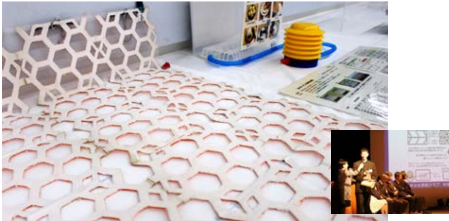
文部科学大臣賞「地球にやさしい泡のカーテン」 ハニカム構造（ハチの巣の構造）のネル素材とメッシュに、ジャガイモの汁の泡を浸して吊るす天然由来のカーテン。泡による断熱効果と気化熱による冷却効果が。右は表彰式での梶さん
