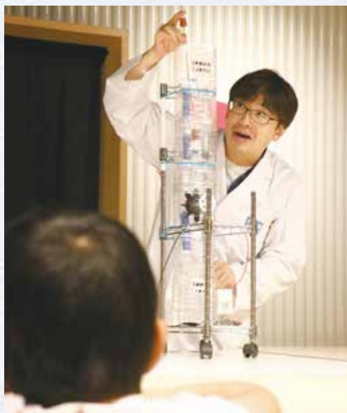
PET ボトルで作ったオリジナル水力発電装置。水を注ぐと……!
