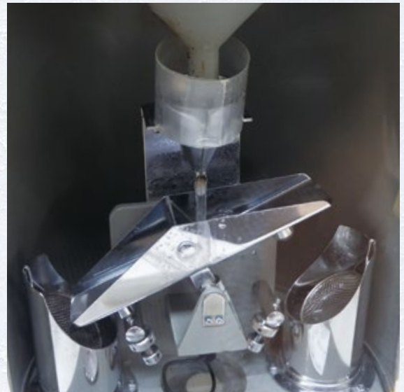
降水量は、「ししおどし」のようなしくみの装置で計測されているのだ
