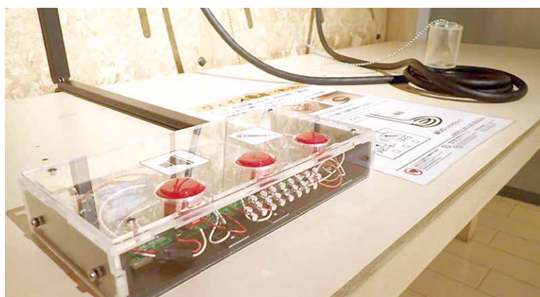
「ヴォイス電流」のマイクをボタン式に改修。押すと音楽が流れ、ケーブル上の磁石で磁界の変化を観察できる
