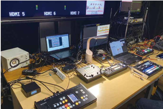
ステージの脇で数台のカメラの映像をスイッチングして配信する
