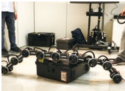
ヘビ型ロボットは1mの段差を越えることも可能。床下・瓦礫上・管内移動、軽作業が可能なのもヘビ型ならではの
