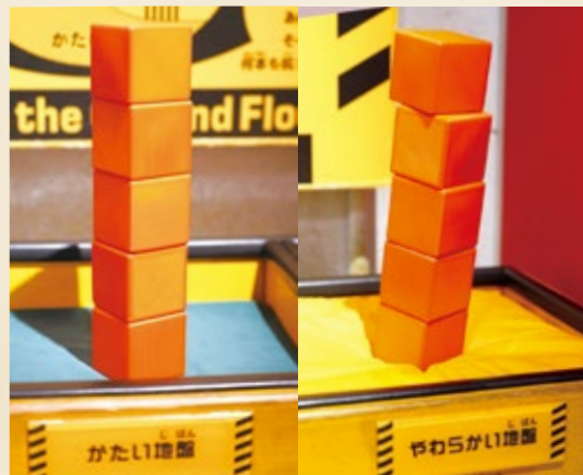
▲「かたい地盤」ではブロックを簡単に積み上げられるが(左)、「やわらかい地盤」(右)ではまっすぐに積むのが難しい。対策ははかいか? (ヒント: 展示室には板も用意してある) ▶新旧ブロック比較。左が現在のブロック。初め硬い樹脂で製作したが、落とすとヒビが入ったため、別の樹脂を使い、問題を解決
