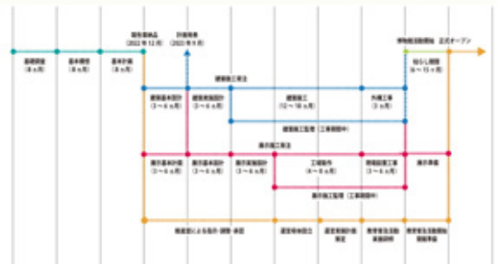
某歴史博物館づくりの流れ 基礎調査から、基本構想、基本計画、基本設計、実施設計、施工、そして正式オープンまで、最初に制作の流れを明確にしておく
